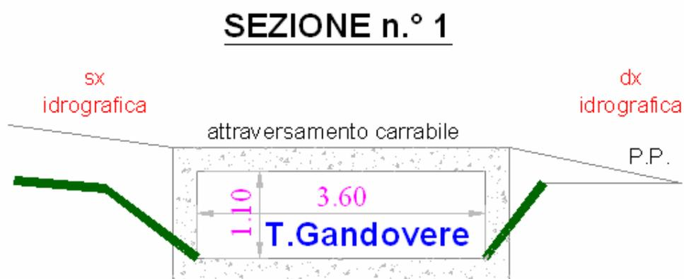
Figura 5: Schema dimensionale sezione di chiusura bacino idrografici n.°1 [disegno fuori scala].
